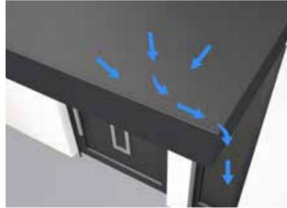
Das Regenwasser wird vom vorderen, erhöhten Rahmenprofil aufgefangen und seitlich abgeführt.
